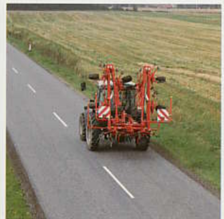
Mechanische schuinverstelling (standaard) voor het schudden van perceelsranden.
