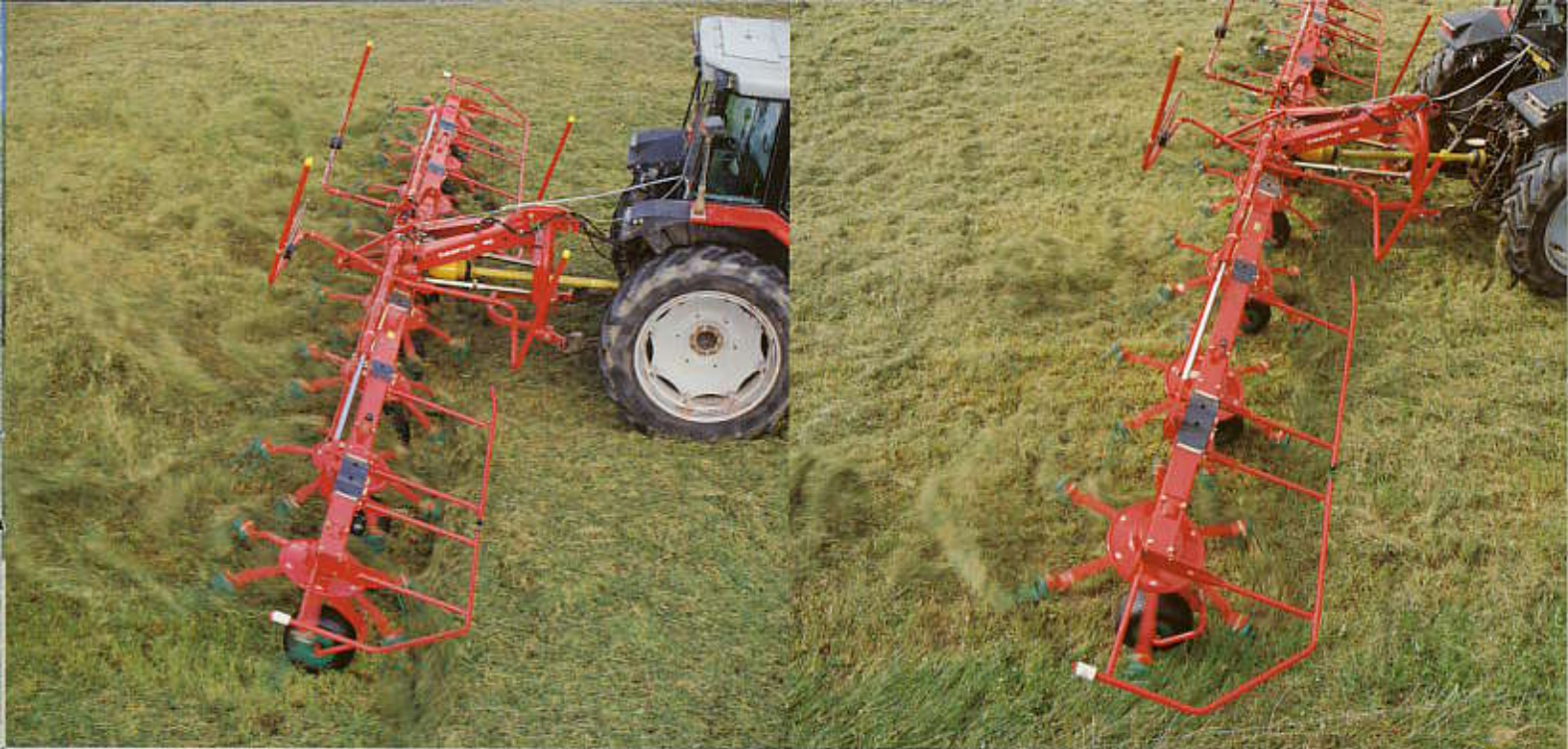
Mechanische schuinverstelling (standaard) voor het schudden van perceelsranden.
