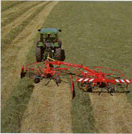
De Taarup 9065S met een werkbreedte van 6.5 m kan samenvoegen tot 11 m gewas in één zwad.
