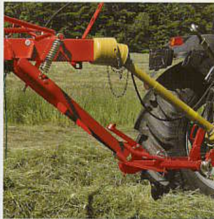
Beide harken zijn voorzien van een dubbele groothoek koppelas met slijp-koppeling.
